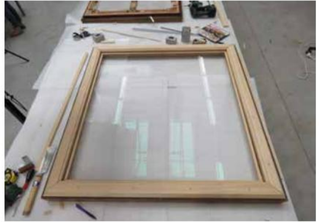
■ Beglazing aanbrengen in een lijst. © Sara Mateu
